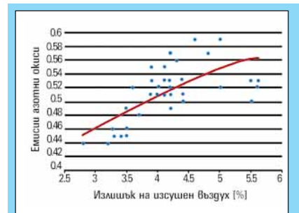
Зависимост между излишъка от въздух и нивото на NOx.
